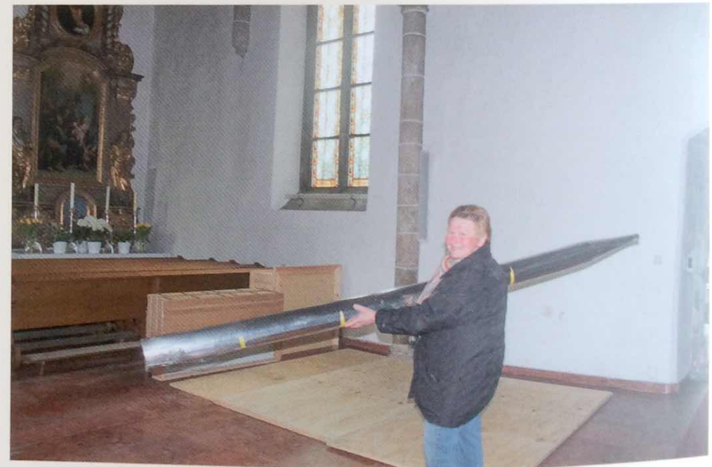
Auf Sand gegossene und gehämmerte Pfeifen
